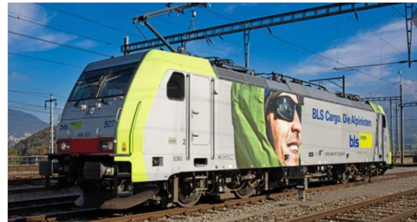
Heutige Umrichterloks wie die Mehrsystemlok von BLS Cargo (Re474) sind deutlich effizienter als die Stufenschalterloks vom Typ Re420 / Re425 / Re430 / Re620. Bild: www.bls.ch .
