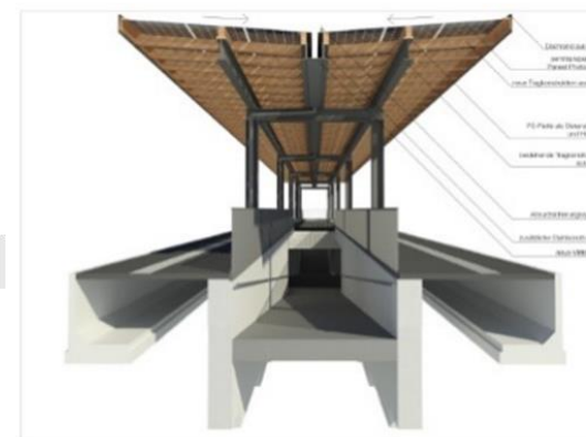
Entwicklungsprojekt für ein semitransparentes, bifaciales Standard-PV-Perrondach (links) und PV-Aufdachanlage auf dem Perrondach in Sargans (rechts). Bilder: SBB.
