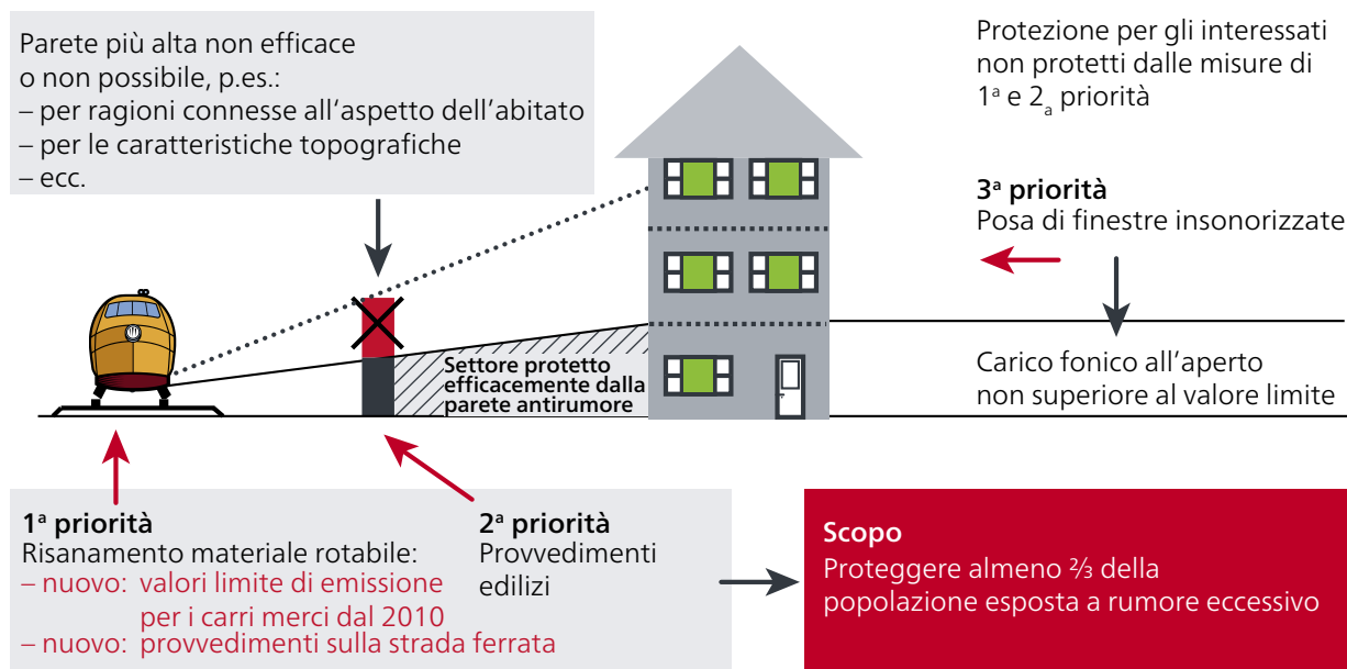
Visualizzazione del piano di misure per il rumore ferroviario
